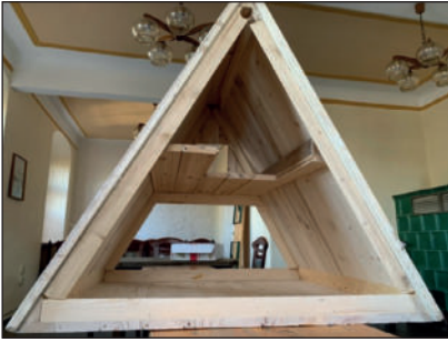
Abbildung 2: Der geöffnete Kasten mit Zwischenboden, aber noch fehlender Reinigungsklappe (hinten) (MARIO SCHOLZ)
